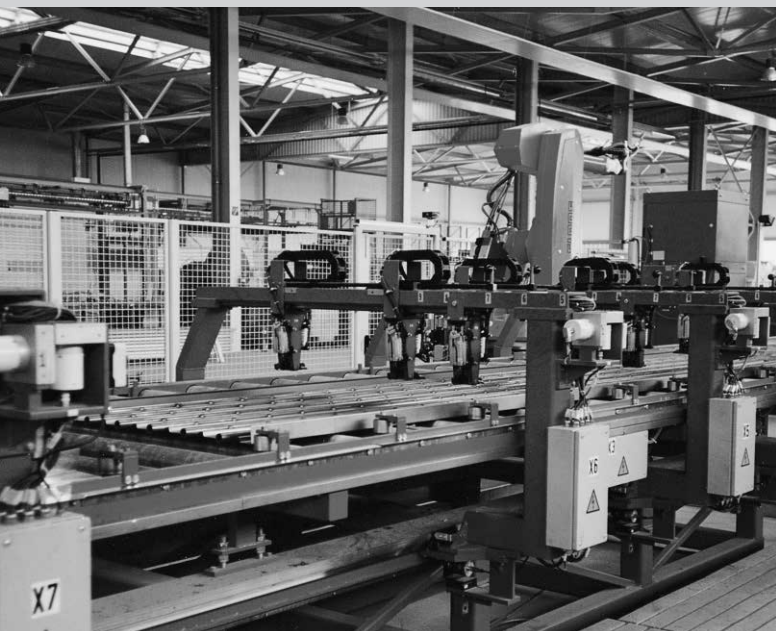
Soudage de la barre transversale à suspendre au moyen d'une installation de soudage robotisée et entièrement automatique
